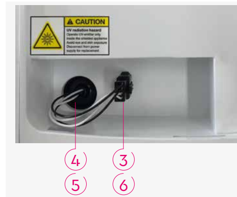
Fig. 9 Hueco de la lámpara UV situado debajo de la cubierta de AQA drink Pro 20
