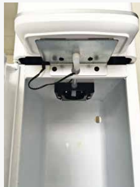
Abb. 6: AQA drink Pro 20 Kabinett innen ohne eingehängten Abwassertank
