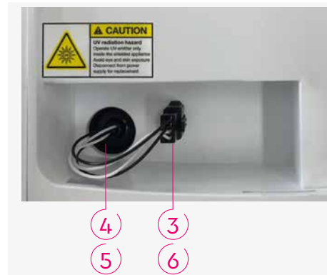
Рис. 9: Разъем УФ-лампы под крышкой AQA drink Pro 20
